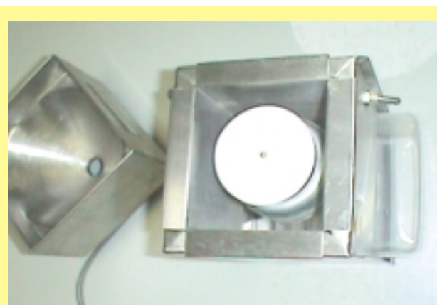
Filtro posizionato sul magnete rotante del Rotaridetector.
